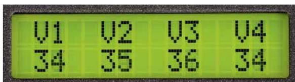
Auf Befehl zeigt das Display die Ruhestrome aller vier Endröhren in Milliampere an (l.). Diese lassen sich bei Bedarf über Mini-Potis nachstellen (u.l.). Kippschalter erlauben verschiedene Betriebsmodi (u.r.).
