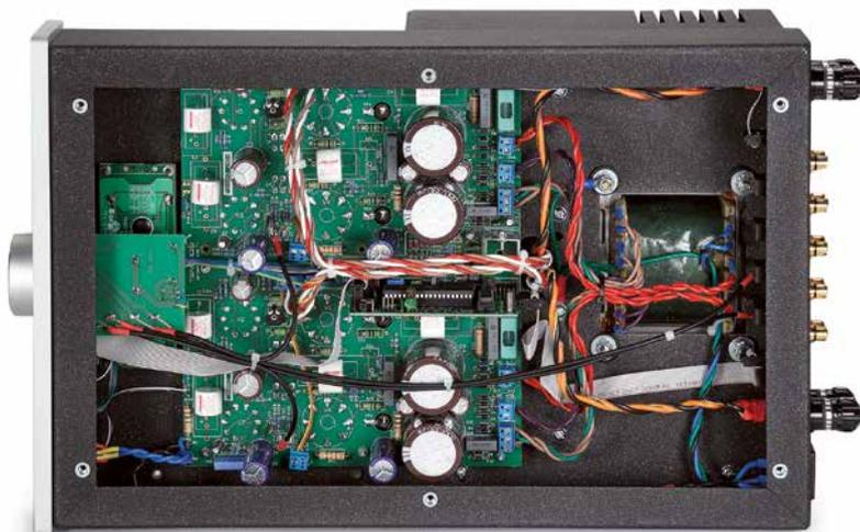
**Die spiegelsymmetrische Platine des Aeolos Ultra ist an einigen Stellen gegenüber der kleineren „Plus“-Version mit höherwertigen Teilen bestückt.**
