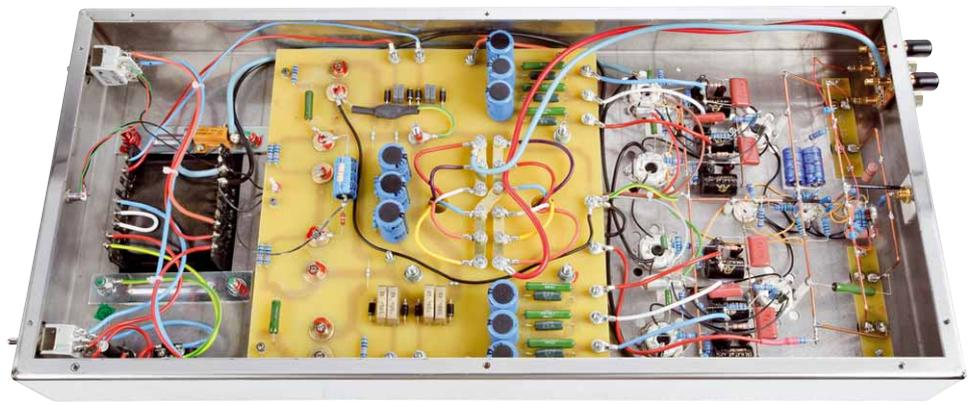
*In der JA120 darf nur die Stromversorgung auf eine Platine, die Audioschaltung ist frei verdrahtet*
