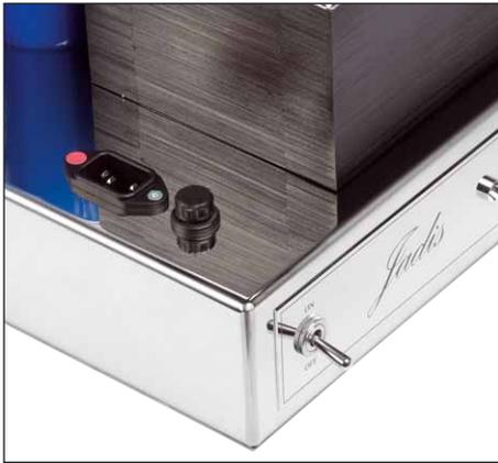
*Der Netzanschluss der Endstufen sitzt vorne beim Netztrafo. Nicht perfekt in Sachen Kabelführung, aber konsequent*
