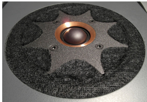
Der Antrieb der Seas-Kalotte basiert auf einer radialen Anordnung mehrerer Neodym-Einzelmagnete, was Reflektionen zurück zur Membran minimiert. Zudem spielt sie recht tief herunter, hilfreich für ein 2-Wege-Konzept. Das sternförmige Dämpfungsvlies soll frühe Reflektionen minimieren
