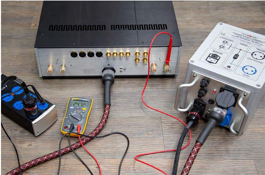
PP 1500 U3 上面有兩顆旋鈕，上面的是粗調，下面的是微調，將兩顆旋鈕上的鎖定裝置鬆開，再將下面的微調旋鈕轉到 5 的位置，以便粗調旋鈕調完之後，微調旋鈕在順逆兩個方向都有空間可調。接著轉動粗調旋鈕，直到電錶顯示出最低電壓（通常在 2V 至 5V 之間），未必要調到最低電壓，因為還有微調旋鈕可用。接著轉動微調旋鈕，將所示電壓微調至更低，約莫在 0.8V 至 1V 即可，然後鎖好鎖定裝置，以免不小心誤轉旋鈕。
