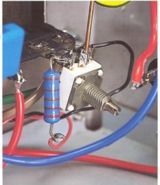
Auch im Einsteigerangebot huldigen die Franzosen ihrer unvergleichlichen Lötkunst (Bild links). Ein Poti sorgt für die Symmetrierung der Wechselspannungs-Heizung (Bild oben)
