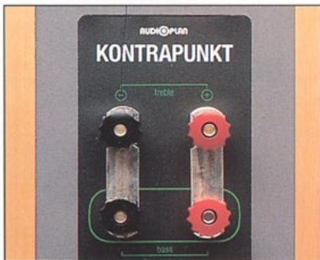
**Die Mk III bietet Bi-Wiring-Option; für den Normalbetrieb werden die Terminals mit dicken Schienen überbrückt**
