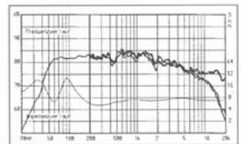
Beide Lautsprecher auf Achse und 30° gedreht in 3 m Abstand, Baßbereich im Nahfeld gemessen; Impedanzkurve
