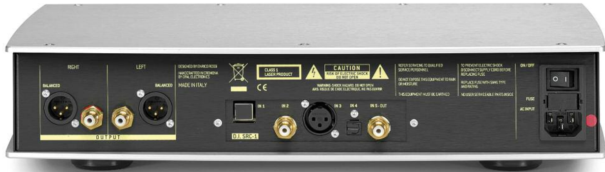
Reich bestücktes Hinterteil: Im Bild links die Cinch- und XLR-Ausgänge, in der Mitte die Eingänge: einmal USB, einmal S/PDIF mit Cinch-Buchse, einmal symmetrisch mit XLR-Buchse und einmal S/PDIF Toslink optisch. Die Cinch-Buchse von Eingang 5 kann auch als digitaler Ausgang konfiguriert werden
