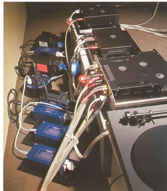
Hinter den Kulissen: Netzaufbereitung mit Filtern und Trenntrafos. Die roten Versa Rolls über den Netz- und Cinchkabeln dienen der "dosierbaren Hochfrequenzblockade".
