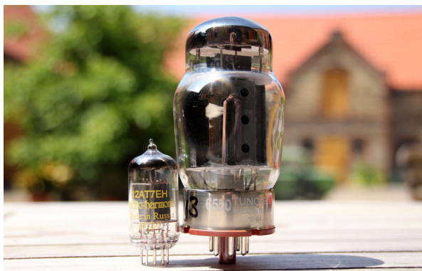
Der Tsakiridis Aeolos+ verwendet 12AT7-Röhren in der Vorstufen- und 6550 in der Endstufensektion
