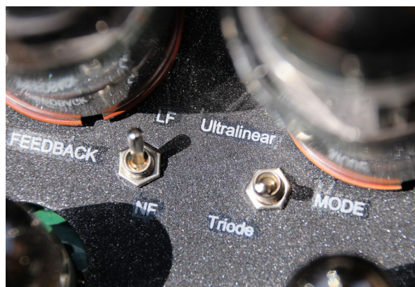
Das Klangbild des Tsakiridis Aeolos+ lässt sich durch die Einstellung der Betriebsart und der Gegenkopplung anpassen – ein echter Vorteil
