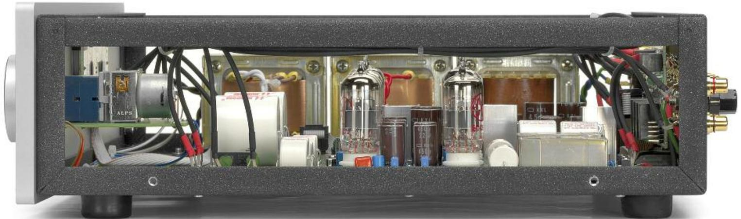
Hier sehen wir die MC-Version des Alexander Phono – gut erkennbar am Lundahl-Übertrager vorne rechts. Bei dieser Version ist MM stets inkludiert, der Betriebsmodus wird per Jumper gewechselt. Wer hingegen „nur“ eine MM-Phonovorstufe braucht, der spart 590 Euro und bekommt Alexander in einer abgespeckten Version ohne MC-Zweig
